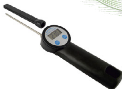
THERMOMÈTRE SONDE SPÉCIAL PÂTE STIL Réf. 193803 Graduation : de - 50°C à + 300°C. Précision : 1°C. Protection IP54. Sonde perçante en acier inoxydable et gaine de protection. Poignée ergonomique. Alimentation par pile 1,5 V fournie.
